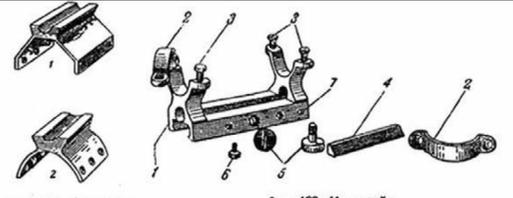
Фиг. 121. Основание кронштейна. 1 — ось граничной ствольной коробки, 2 — ось круглого ствольного корпуса. Фиг. 122. Кронштейн. 1 — передняя часть, 2 — верхняя часть (полукорпус), 3 — винты полукорпуса, 4 — клин, 5 — боковые винты, 6 — винт клина, 7 — винт вставки.
